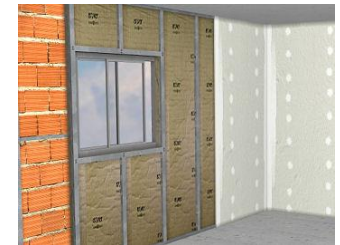
U = 0,66 \text{ W/m}^2\text{K} TRASDOSAT LLANA DE ROCA de 4,50cm
