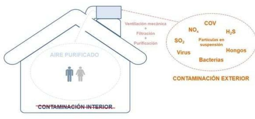
Imagen – sistema de filtración del aire en Passivhaus
